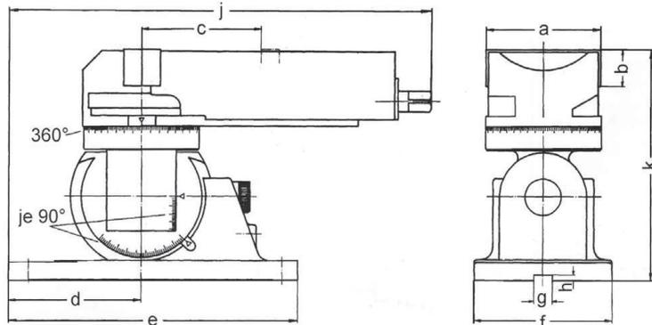
Spannkraft: max. 10 kN bei ca. Anzugsmoment 30 Nm
